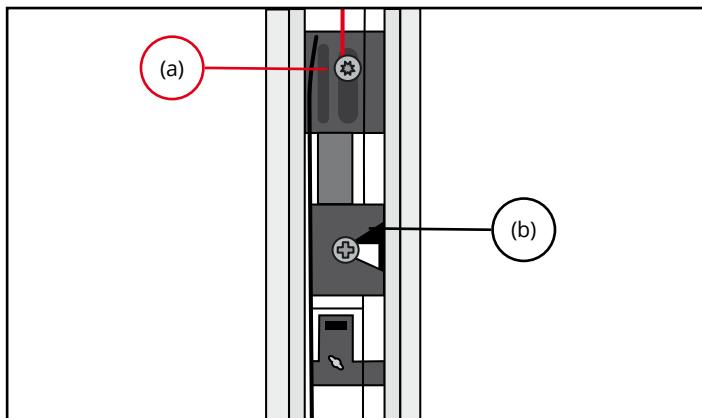
Voor het nastellen van de koordspanning, hoeft u het borsteldrager profiel niet te verwijderen.
