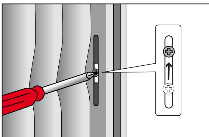
**Koordspanning controleren:** Te slappe koordspanning: de hordeur loopt erg licht en de treklijst valt iets terug.
