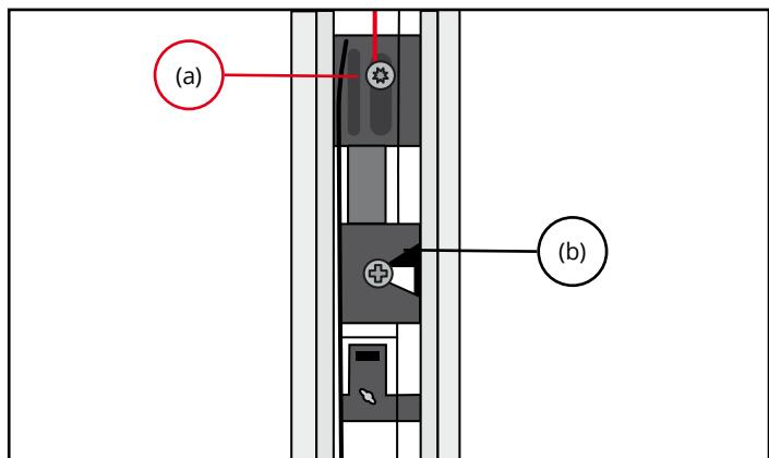
Für das Einstellen der Schnurspannung müssen Sie das Bürstenprofil nicht entfernen.
