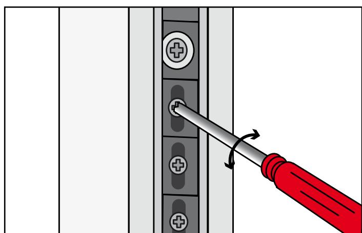
**Koordspanning controleren:** Te slappe korrdspanning: de hordeur loopt erg licht en de treklijst valt iets terug.
