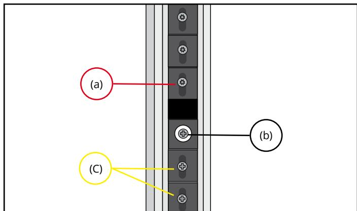
Die Einstellschrauben befinden sich hinter dem Bürstenprofil. Sie können dieses Profil mit einem Schraubendreher aus dem Zugstreifen klicken.
